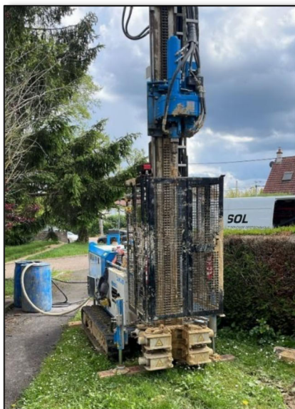
21/05/2024 : Sondage destructif avec essais pressiométriques SP2
