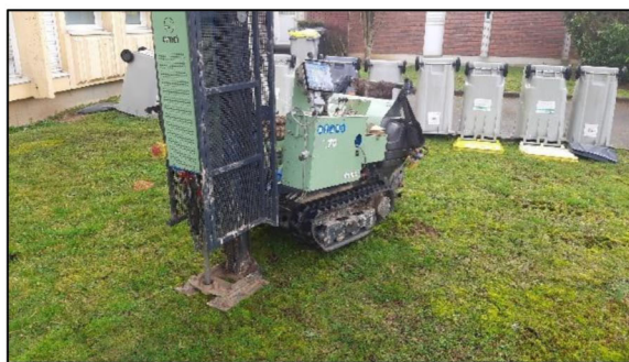
23/02/2023 : Essai au pénétromètre dynamique PD1'
