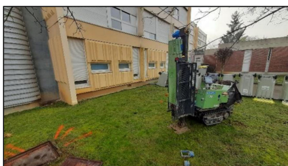
23/02/2023 : Essai au pénétromètre dynamique PD1'BIS
