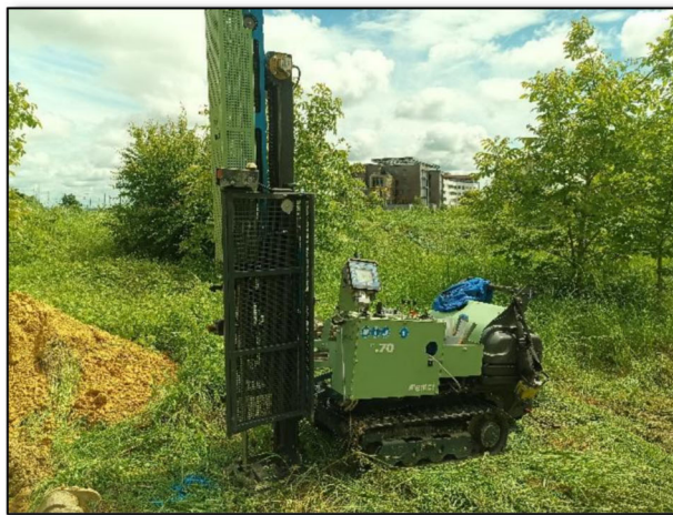
Figure 1 - Essai au pénétromètre dynamique lourd de type B – 21/05/2024
