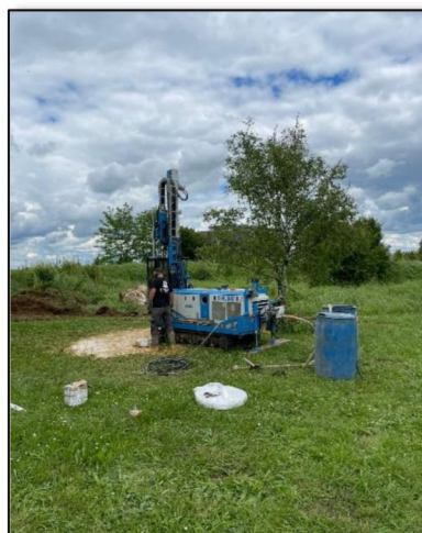
21/05/2024 : Sondage destructif avec essais pressiométriques SP1
