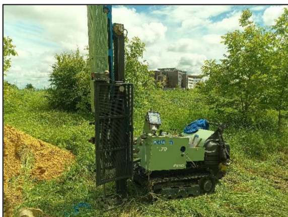
21/05/2024 : Essai au pénétromètre dynamique PD5
