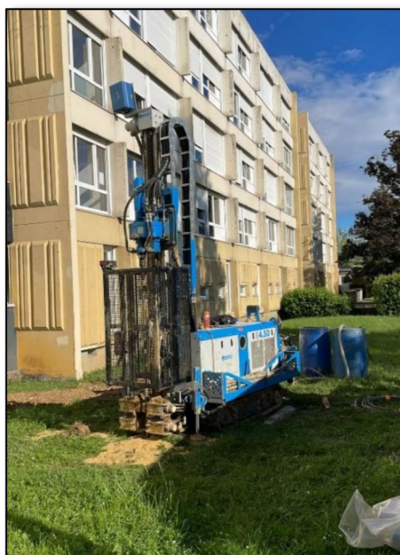
21/05/2024 : Sondage destructif avec essais pressiométriques SP3
