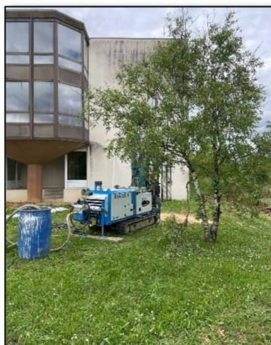
21/05/2024 : Sondage destructif avec essais pressiométriques SP1
