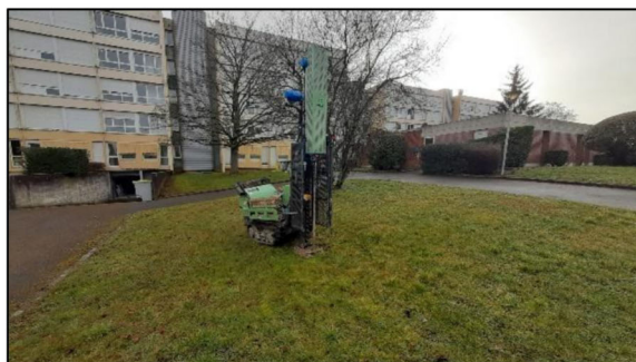
23/02/2023 : Essai au pénétromètre dynamique PD2'
