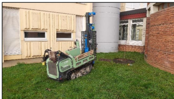
23/02/2023 : Essai au pénétromètre dynamique PD3'
