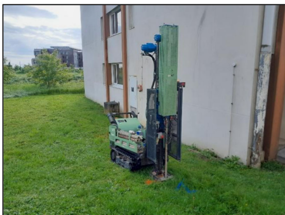
21/05/2024 : Essai au pénétromètre dynamique PD1
