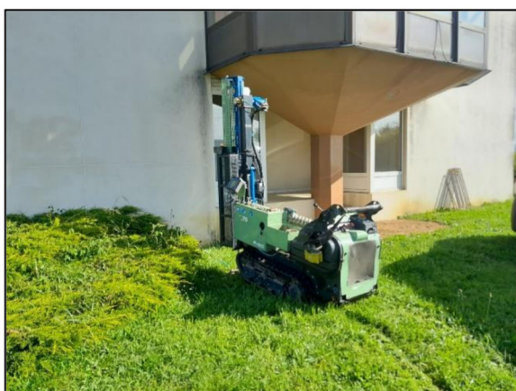
21/05/2024 : Essai au pénétromètre dynamique PD2
