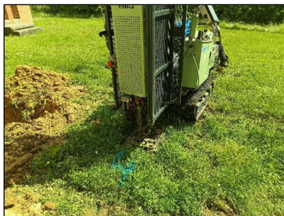
21/05/2024 : Essai au pénétromètre dynamique PD4
