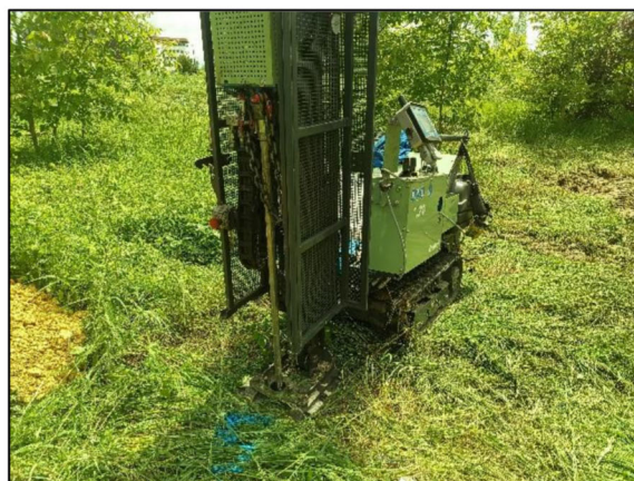
21/05/2024 : Essai au pénétromètre dynamique PD5
