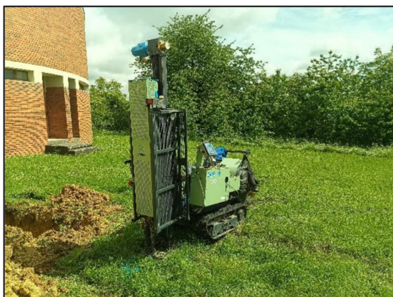
21/05/2024 : Essai au pénétromètre dynamique PD4
