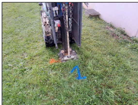
21/05/2024 : Essai au pénétromètre dynamique PD1
